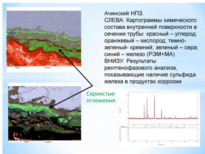
Рис.5. Пример применения растровой электронной микроскопии в сочетании с рентгеновским микроанализом (РЭМ+МА) и рентгенофазовым анализом для исследования микроструктуры коррозионного поражения трубы газодифракционной установки (данные РЦ «Нанотехнологии» и РЦ «Рентгенодифракционных методов исследования» СПбГУ)
